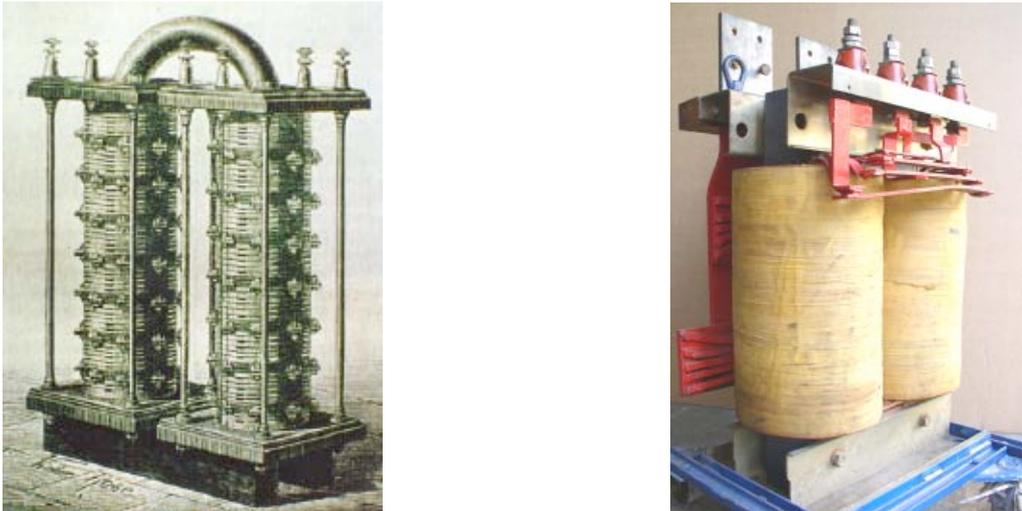
**Figure 1** : « générateur secondaire » de L. Gaulard et transformateur actuel.
