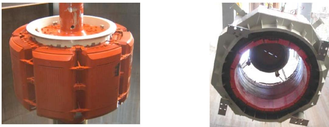
Figure 5 : rotor et stator d'une machine synchrone (alternateur hydraulique de 110 MVA – 750 tr/min) d'Alstom (photos Alstom).
