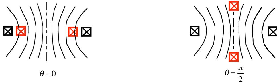
**Figure 2** : positions extrêmes des deux enroulements 1 & 2 : en phase et en quadrature. Lignes de champ créées par l'enroulement 1.
