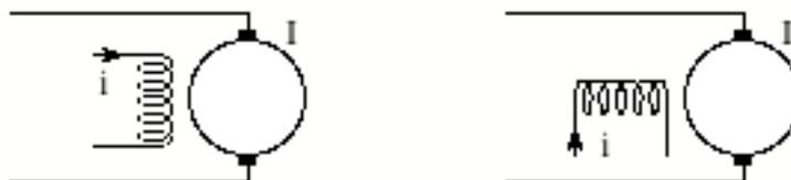
**Figure 2 :** représentation d'une machine à courant continu.
