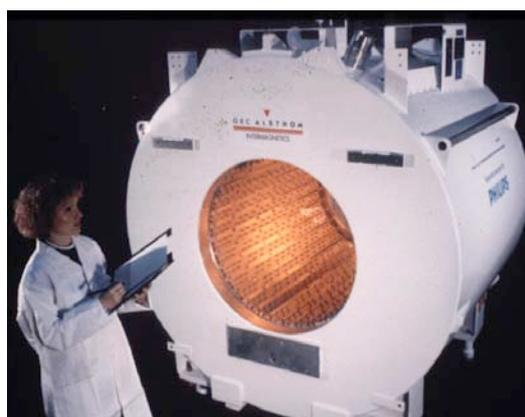
**Figure 4** : aimant supraconducteur pour imageur IRM (Imagerie par Résonance Magnétique) (photo Alstom).
