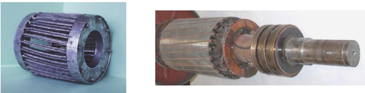
**Figure 1** : cage d'écureuil du rotor et rotor bobiné d'une machine asynchrone.
