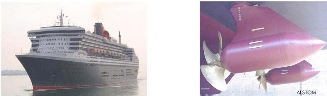
**Figure 3** : Queen Mary (4 x 19,5 MW) et PODs (2x19,5 MW) du navire "Millenium" (documents Alstom).
